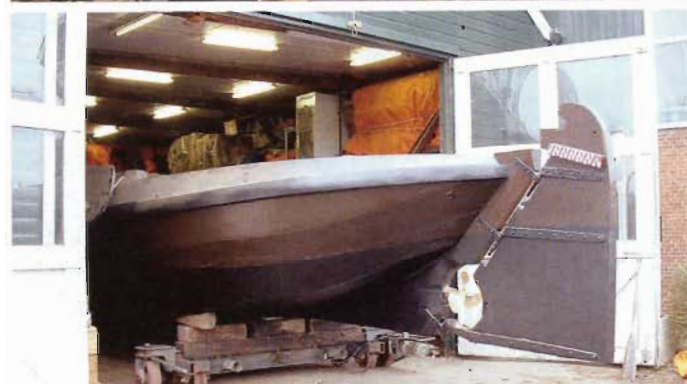
De botter ZS 13 kreeg een nieuwe voor- en achtersteven, een droge bun, vlak en kielbalk.
