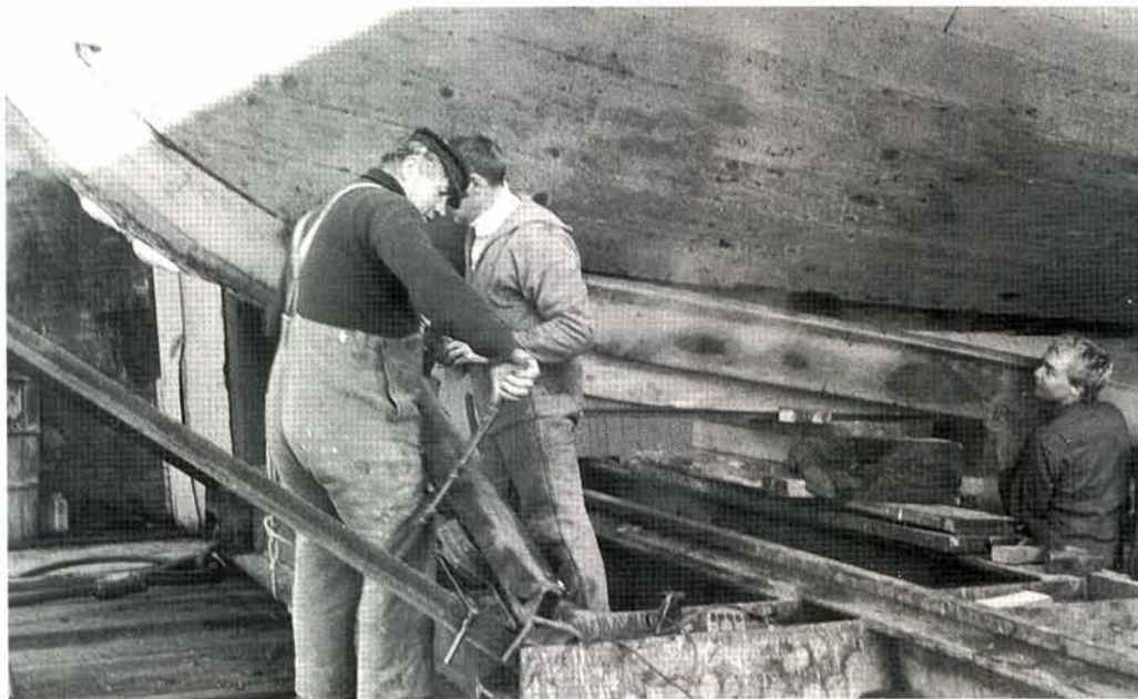
Lulu, Henny en Olivier plaatsen een nog dampende nieuwe kielgang
