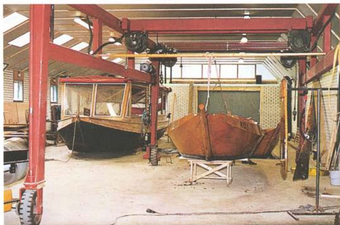
Op de voorgrond zien we de moderne botenlift die over het bassin (achter de punter) kan worden gereden en de schepen uit het water kan tillen.
