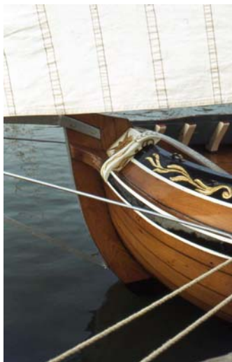
Froukje (ex. Zwaluw) ca. 1980 duidelijk zichtbaar het vergulde lofwerk op het boeisel de vergulde ster op het kluisbord en daar tussen in de uitgesneden beretand. De zwarte rand met witte biezen onder en boven is het berghout. (foto GTC).
