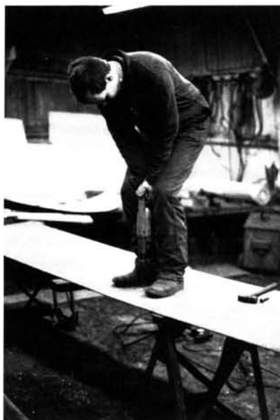
Het voorbereiden van de klinknagelgaten
