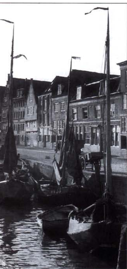
Binnenhaven van Hoorn met op de voorgrond drie ijzeren spekbakken, in dit geval schouwen die sterk contrasteren met de twee houten botters op de achtergrond. (Foto ir. WF van Heemskerck Duker)
