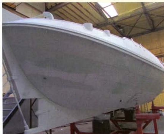
Nadat al het laswerk is afgerond, kan al het ijzerwerk worden ontvet, de primer worden bijgewerkt en kan alles in de epoxy worden gespoten.
