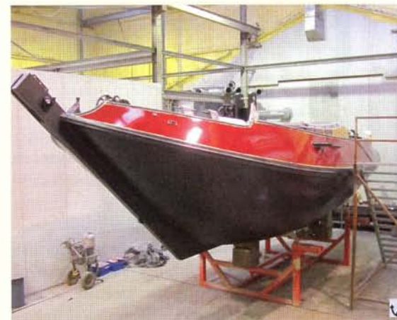
Het 12,25 m schokkercasco is afgeschilderd en er kan met de betimmering worden begonnen, waarover in een volgend artikel meer.
