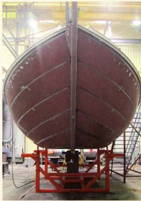
Aan de buitenzijde is het casco afgelast. De vorm van de romp is goed zichtbaar.
