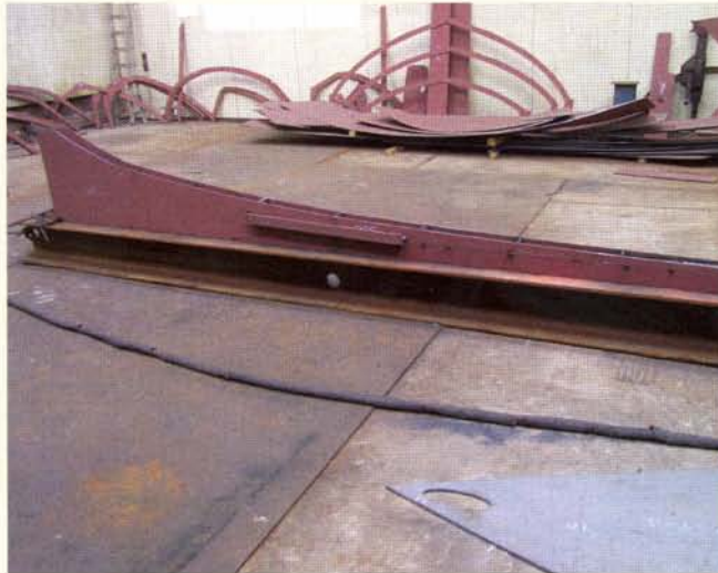
Voor en achter loopt de 15 mm dikke bodemplaat omhoog. De plaat krijgt vlaktiling voor een beter vaargedrag. Op de achtergrond liggen de voorgevormde huidplaten en al wat samengestelde spanten klaar om te worden opgesteld.
