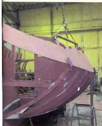
vastgehecht en dan kan de, steven worden geplaatst.
