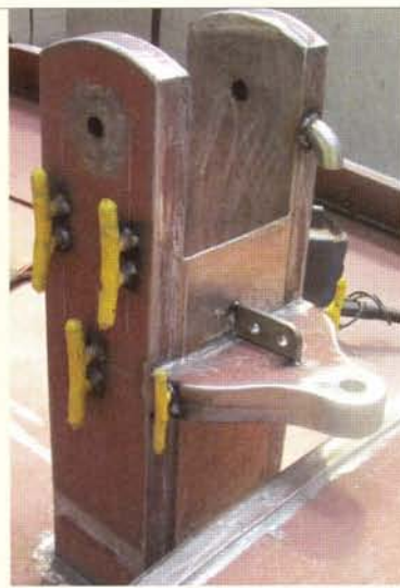
Het samenstellen en het aflassen van de mastkoker kost veel tijd.
