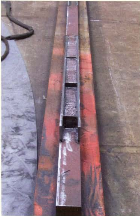
De massieve kielbalk van 10 x 10 cm vormt een stevige ruggengraat van het schip. Het dient tevens als laaggeplaatste ballast.
