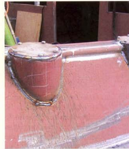
De funderingen voor de lieren langs de kuip zijn vast gelast en moeten nog geslepen worden. Het schroefdraad voor de lierbouten is al getapt.
