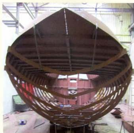
Het spantenraam van de 12,25 m schocker is nu goed zichtbaar. De huidplaten moeten stuk voor stuk in de vorm worden gewalst. Een heel precieze klus voor staalbewerker Arnold.
