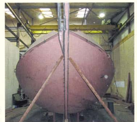
De huid zit om de spanten. De voorsteven met snoes maakt er al een echte schocker van.
