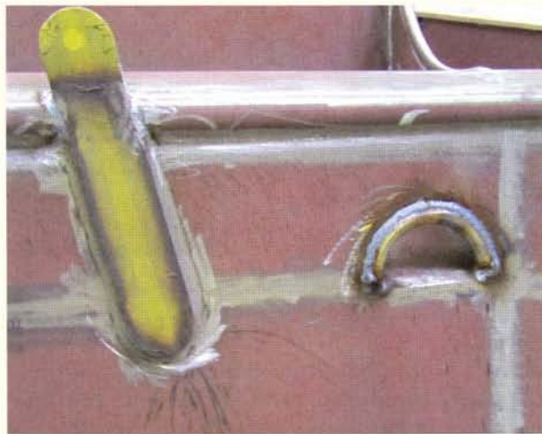
Wandputtings, waterloopgaten, alles kost zorg en tijd. Auke besteedde veel tijd aan het vlaklijpen van de lasnaden.
