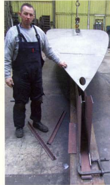
Arnold bouwt al vele jaren casco's in alle maten bij Scheepsreparatie Friesland. Hier wordt de vlakplaat op de kielbalk gelegd, met een gewicht van twee ton staal wordt het in de gewenste vorm gedrukt.
