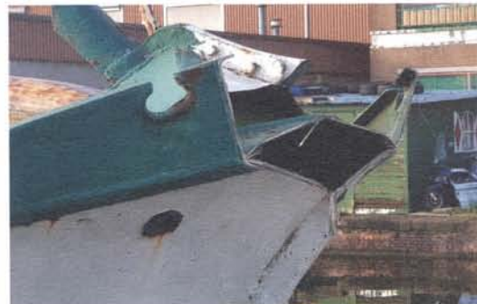
Om het schip te laten voldoen aan de officiële eisen wordt het 'puntje' beweegbaar gemaakt zodat de officiële vaste lengte van het schip onder de 20 meter komt.
