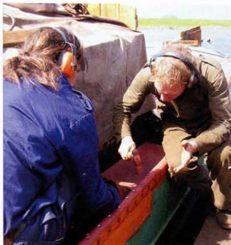
De kop van de nagel wordt rond geklopt.
