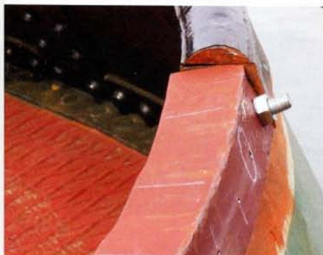
Een nieuw stuk potdeksel wordt pasgemaakt en tijdelijk met bout en moer vastgezet.
